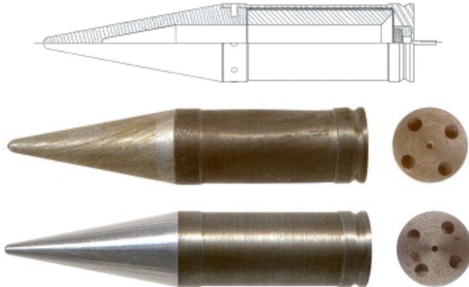
Fig. 28-76. MBA 20mm Subcaliber Swarmjets. Actual size.
