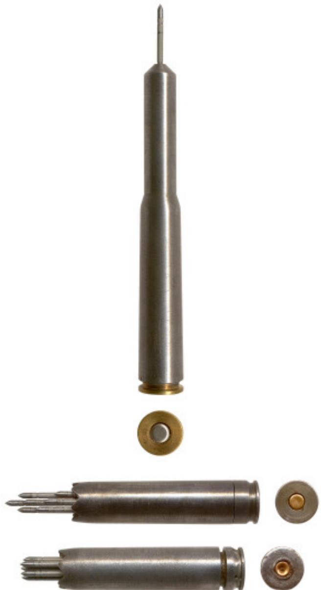
Fig. 28-20. 1.5mm Lancejet cartridges. Actual size.
