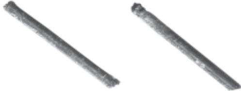
Fig. 28–36. MBA Methocel/tungsten mix Javette nose preforms, enlarged from actual size. MBA photo.
