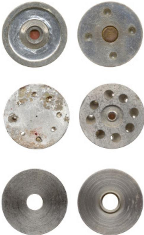
Fig. 28-58. MBA 30mm steel rocket nozzles. Actual size.
