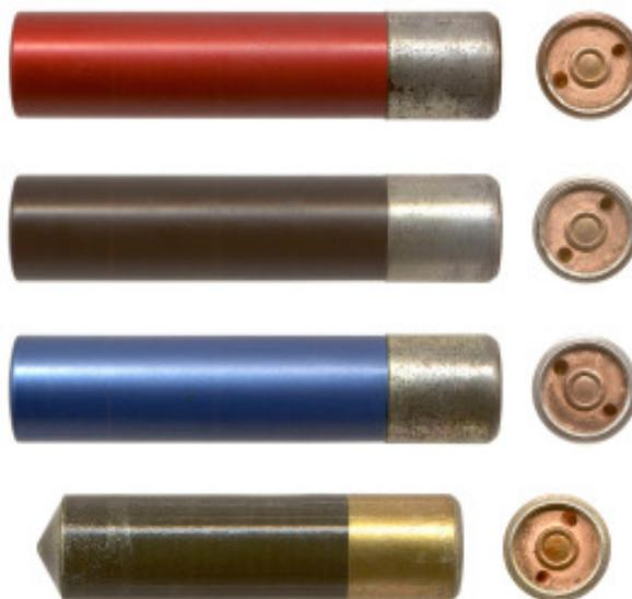
Fig. 28-71. 13mm Gyrojet flares. Actual size.
